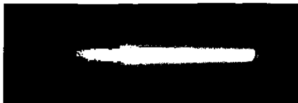
Рис. 2. Сверхзвуковая струя воздуха с температурой 4700°К.
